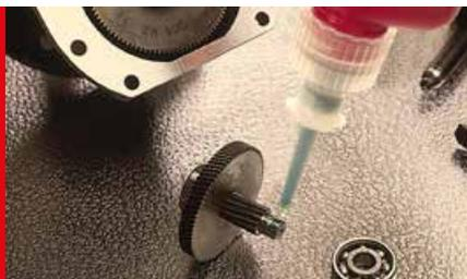
Applicare l'adesivo sul bordo esterno del maschio e all'interno della femmina e assemblare ruotando per bagnare completamente le parti di adesivo
